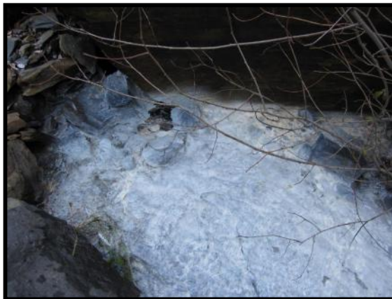
Figura 27. Lixiviados de oxi-hidróxidos de aluminio. Arroyo de la Fuente Lamocos.
