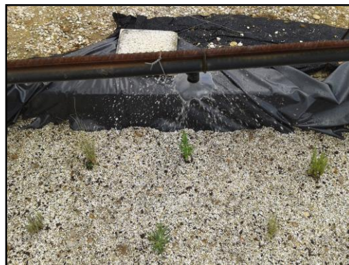
Figura 13. Sistema de riego por aspersión instalado en las parcelas experimentales.
